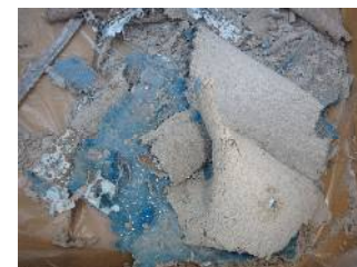
はく離除去塗膜の回収状態 ≒ 「湿潤シート状態」
