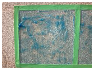
バイオハクリ21A 塗付後24時間経過状態 ② ① 塗付パターンA 塗付量 1.0kg/m 2 の状態
