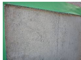
① 塗付パターンA 塗付量 1.0kg/m 2 塗膜はく離完了状態 塗膜はく離除去作業完了状態
