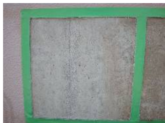
① 塗付パターンA 塗付量 1.0kg/m 2 塗膜はく離完了状態 塗膜はく離除去作業完了状態
