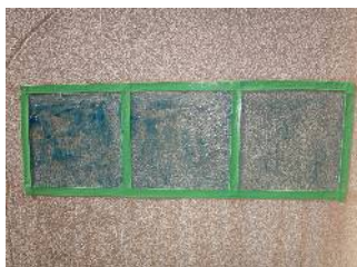
バイオハクリ21A 塗付後24時間経過状態 ① 左から ① 塗付パターンA 塗付量 1.0kg/m 2 ② 塗付パターンB 塗付量 0.8kg/m 2 ③ 塗付パターンC 塗付量 0.5kg/m 2
