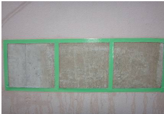
塗付後24時間経過後の塗膜はく離作業結果
