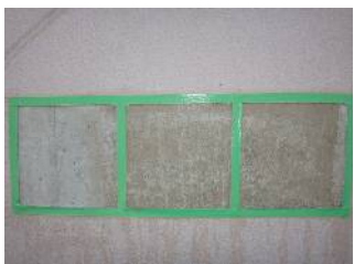
バイオハクリ21RE 塗付後24時間経過状態 ① 左から ① 塗付パターンA 塗付量 1.0kg/m 2 ② 塗付パターンB 塗付量 0.8kg/m 2 ③ 塗付パターンC 塗付量 0.5kg/m 2
