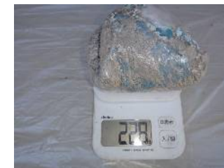
はく離回収した塗膜重量測定状態 228g/0.09m 2 ≒ 2.533g/m 2 (回収塗膜および養生マスクー含む)
